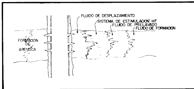
Figura IV.18 Técnica de estimulación matricial reactiva en arenisca.
